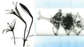
(左)ゆりの花 (右)かぶと虫 中性子ラジオグラフィによる透過写真
